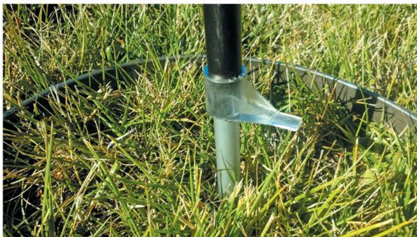
Foto 9. Medición de la altura sin disturbar en una pradera. La lengüeta se baja hasta que toque la primera hoja.
