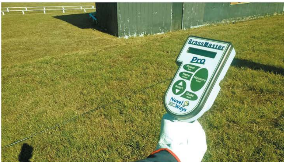
Foto 13. Microprocesador del equipo medidor de disponibilidad de forraje por capacitancia. Permite lectura directa de la disponibilidad de forraje.
