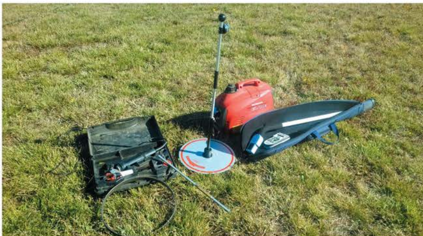
Foto 8. Equipo de muestreo: tijeras eléctricas, grupo electrógeno, marco de muestreo, instrumentos de medición (plato y capacitómetro).
