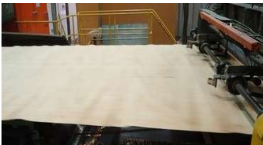
Figura 10. Proceso de debobinado de la troza de E. nitens , para la obtención de chapas, para ser utilizadas en la confección de los tableros contrachapados.
