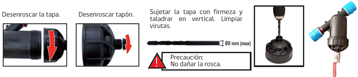
Figura 24. Pasos para la instalación de una llave de paso al extremo del filtro.
