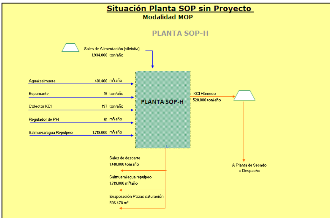
FIGURA 7: DIAGRAMA DE FLUJO: PROCESO PLANTA SOP-H (MODALIDAD MOP)
