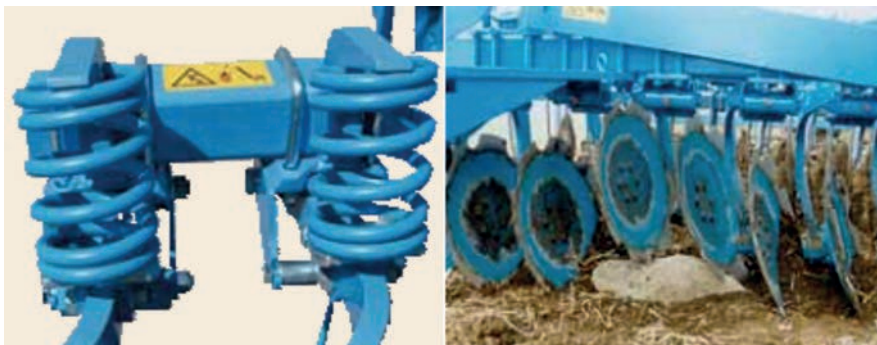
Foto 4.6. Óptima suspensión de los discos. Lemken, 2013.
