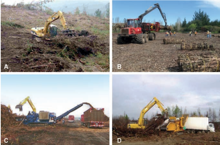
Foto 10.5 A) Acopio de residuos de cosecha por excavadora. B) Aprovechamiento de residuos de Eucalyptus con enfardadora. C) Astillado de residuos con triturador Peterson 4710 B. D) Astillado de residuos con triturador CBI Magnun Force 8400.
