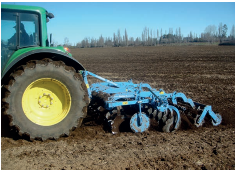
Foto 4.4. Rastra mezcladora de rastrojos marca Lemken modelo Rubin 9. (Foto Jorge Riquelme).
