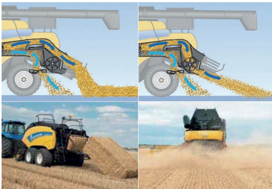
Figura 4.1. Sistema de cambio rápido de acuerdo a la necesidad del manejo de rastrojo. (New Holland Brand Communication, 2007).
