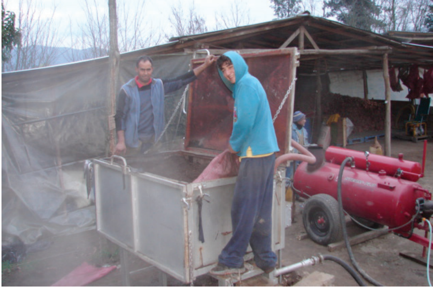
Figura 6.6. Equipo para desinfectar a través de vaporización, el sustrato para utilizar en la confección de plantines.
